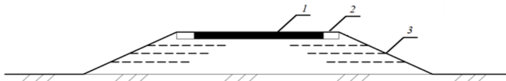
Рисунок 1 — Поперечный профиль земляного полотна
